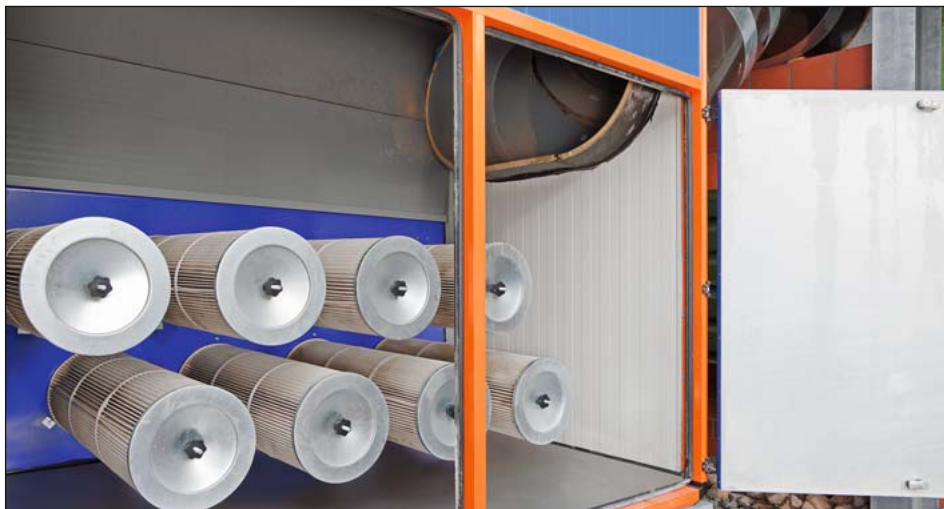
Unidad de filtro de celulosa – procura que sólo aire de escape limpiado de la nave entre en el paquete de intercambiador
