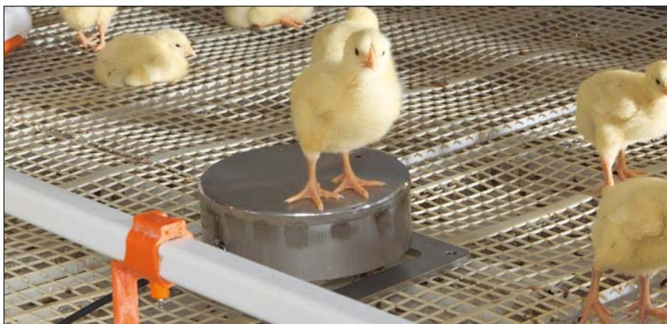
**IncasCompact** es una báscula desarrollada por Big Dutchman para pollos Broiler en el sistema de jaulas AviMax. Está totalmente fabricada en acero inoxidable y tiene una plataforma de pesaje redonda con 15 cm de diámetro.
