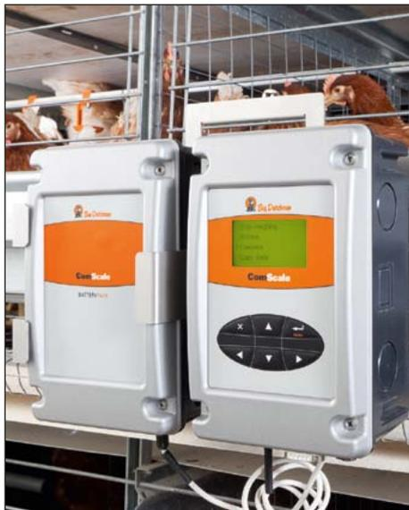
**ComScale** es un ordenador de pesaje que se utiliza como dispositivo independiente y se emplea de forma fija en la sala de control, o bien de forma portátil gracias al funcionamiento con batería. Tanto las básculas de aves Swing 20 y 70, como las básculas Incas 2 e IncasCompact se pueden conectar a ComScale.
