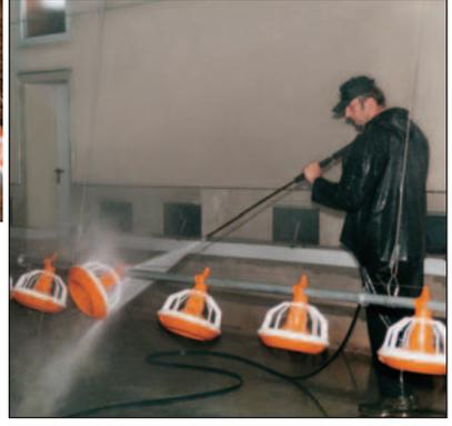
Higiene – un tema importante. Dirigir el chorro de agua a presión hacia el plato. Éste empieza a rotar y así se limpia eficientemente y en profundidad.
