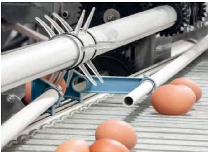
> Système de ramassage des œufs Lift - bande transporteuse "Anaconda"
