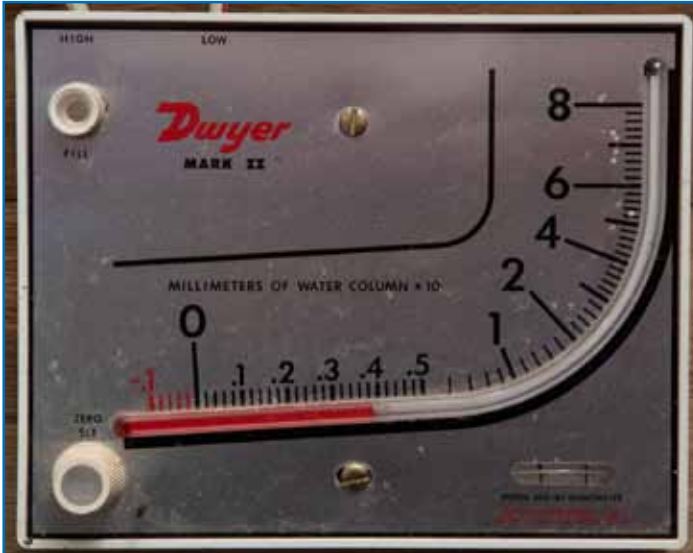
Figura 104: Manómetro utilizado para supervisar la presión del aire dentro de la nave (la medida que se muestra es equivalente a 0,15 pulgadas columna de agua).
