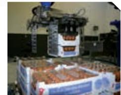
**1** MR 50 despaletiza palés con huevos. Las pilas se sitúan en el cargador de huevos. El robot localiza cada capa, por lo tanto no es necesario alinear previamente los palés antes del procesamiento, evitándose el riesgo de generación de fisuras asociado.
