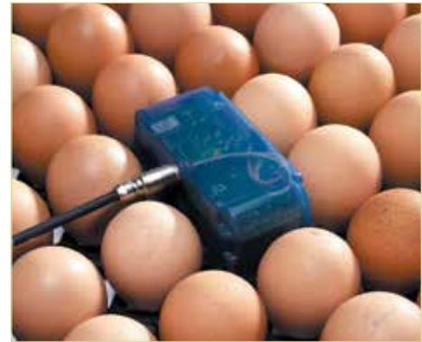
^ Sensor OvoScan™ posicionado en la bandeja de incubadora
