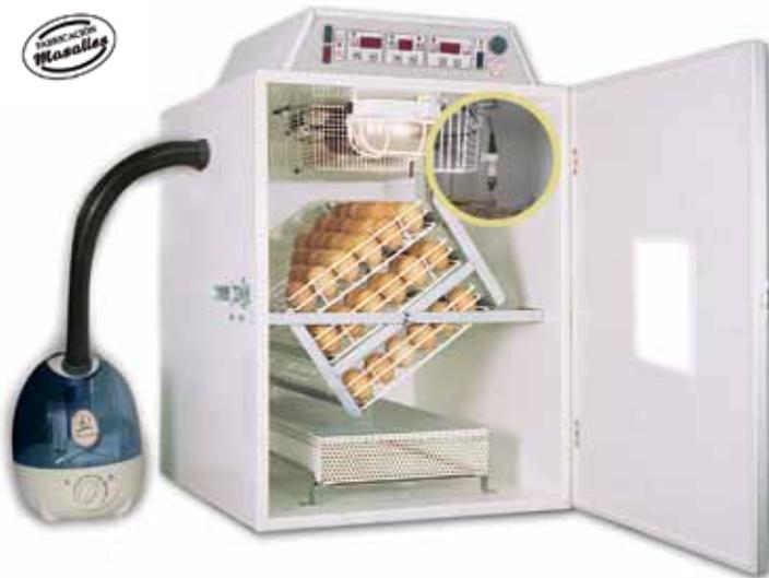
Humedad automática mediante nuevo sistema de inyección de vapor frío electrónico **HS-SINF**. Funciona sin aporte de calor (sin resistencias) para evitar descompensaciones en la temperatura interior de la incubadora. Sistema externo para facilitar limpieza y desinfección. Sin problemas de concreciones calcáreas. Depósito exterior de agua 3,5 l para la humedad.
