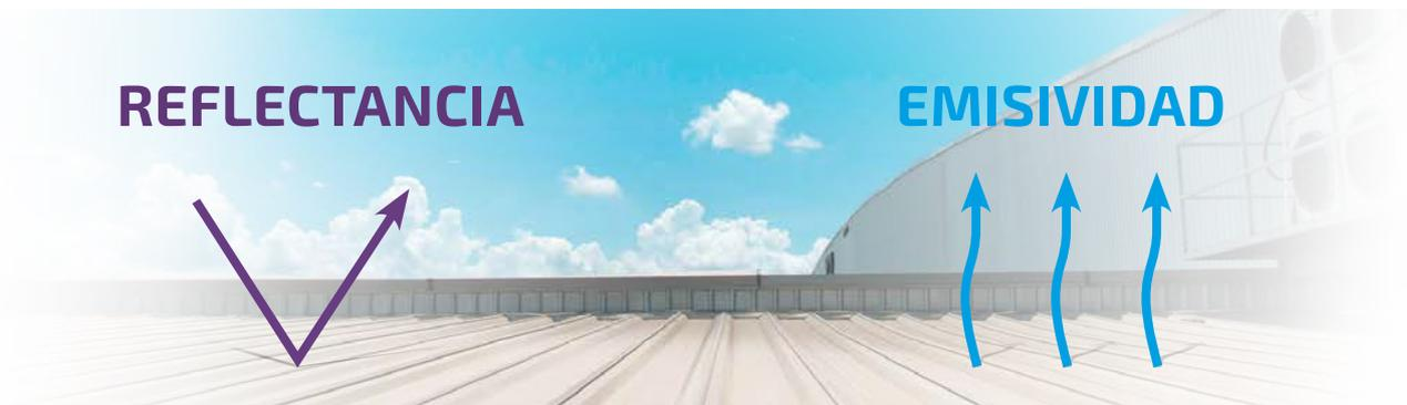
Aparte de una alta reflectancia, los materiales para cubiertas también deberán caracterizarse por una alta emisividad, que es la capacidad de disipar el calor absorbido de la energía solar.
